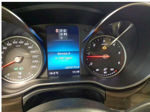
**Beschädigung 1:** Instrumententafel: Kontrollleuchte (Motorkontrolle) - leuchtet - Diagnose durchführen
