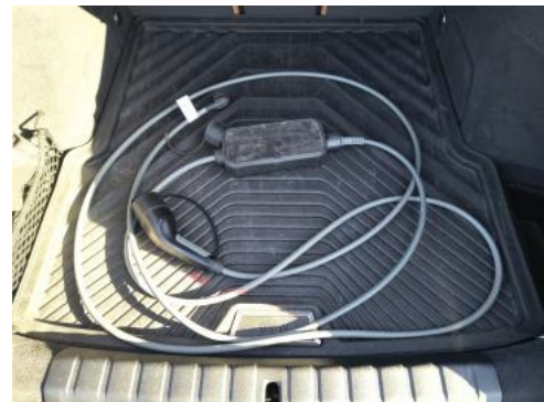
Fot. 28 Przewód ładowania baterii trakcyjnej
