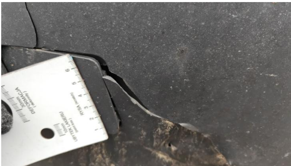
Fot. 69. Zderzak n/lakier. PRZ - pęknięcie 1
