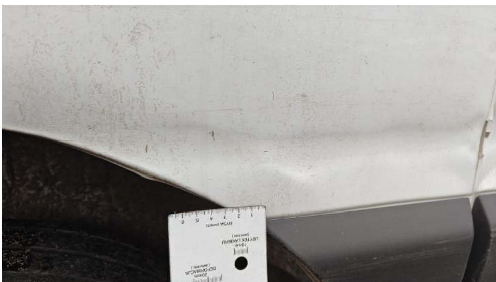
Fot. 34. Błotnik metal TP - wgniecenie 2
