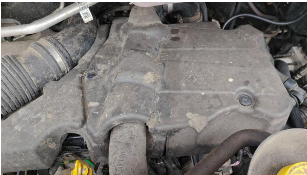
Fot. 67. Mata wygłuszająca pokrywy - rozerwanie 1
