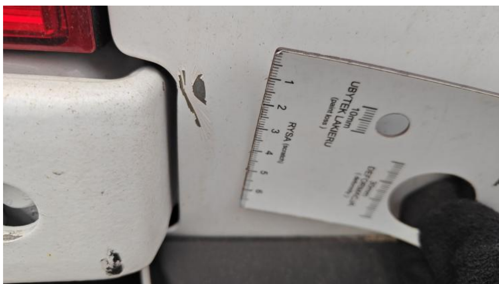
Fot. 50. Drzwi skrzydłowe TL - wgniecenie 1
