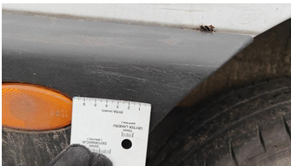
Fot. 46. Listwa błotnika n/lakier. TP - zarysowanie 2
