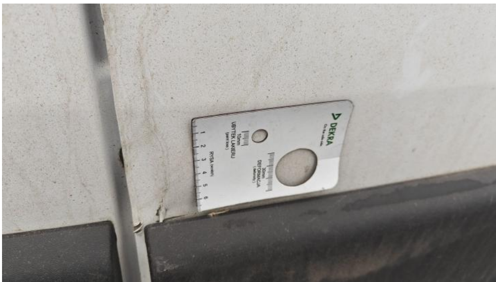
Fot. 37. Drzwi skrzydłowe TP - wgniecenie 2
