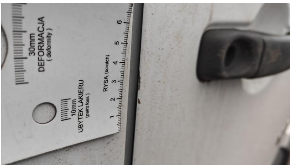
Fot. 38. Drzwi skrzydłowe TP - zarysowanie 1
