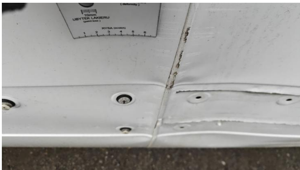
Fot. 62. Ściana boczna TL() - wgniecenie 3
