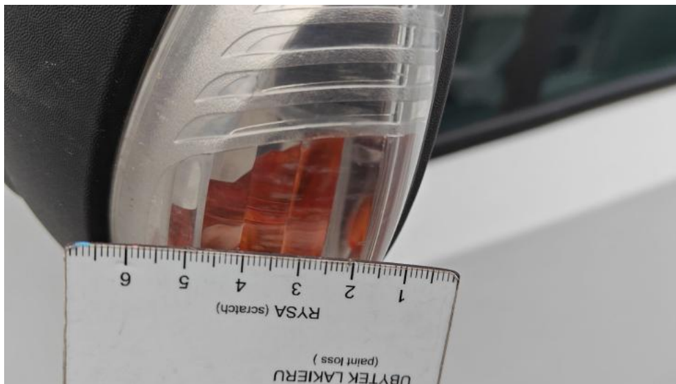
Fot. 85. Kierunkowskaz lusterka żarnikowe L - zarysowanie płytkie 1
