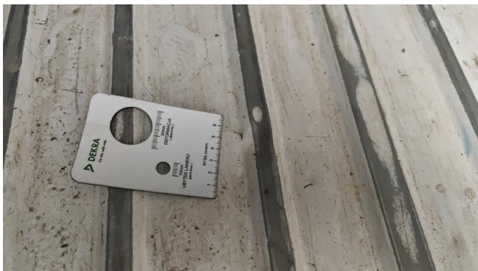
Fot. 102. Podłoga bagażnika - wgniecenie 2
