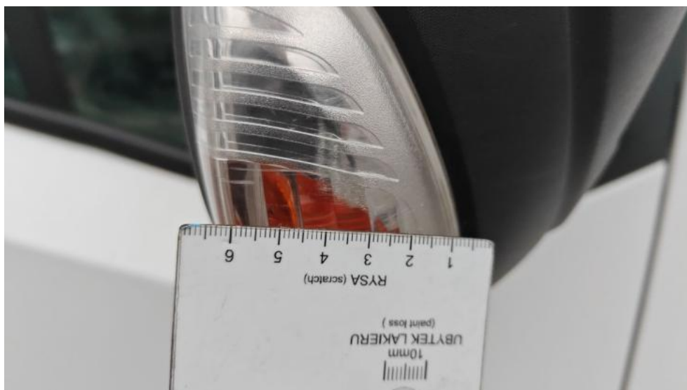
Fot. 76. Kierunkowskaz lusterka żarnikowe P - zarysowanie płytkie 1
