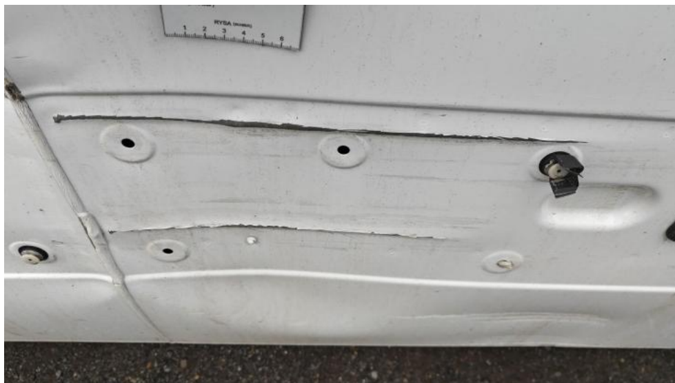
Fot. 61. Ściana boczna TL - wgniecenie 2
