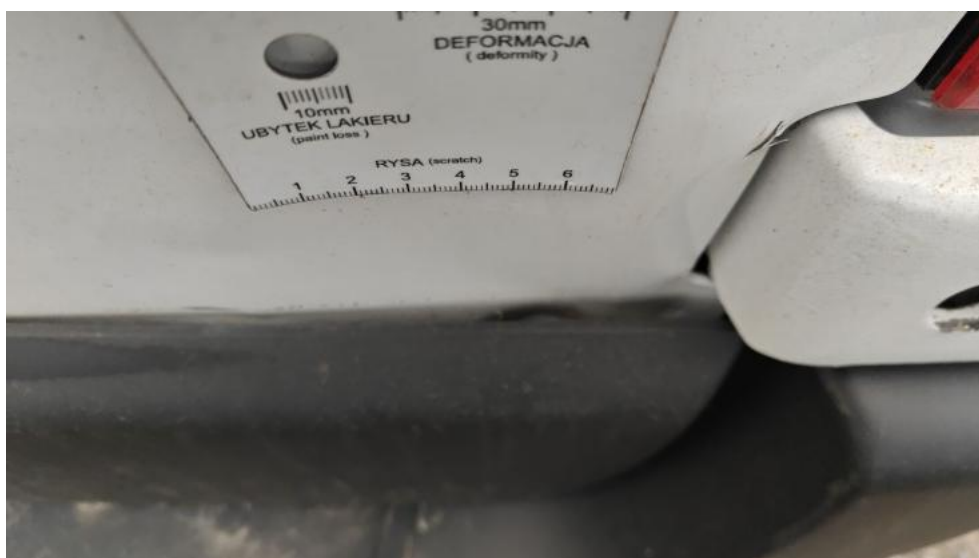
Fot. 36. Drzwi skrzydłowe TP - wgniecenie 1
