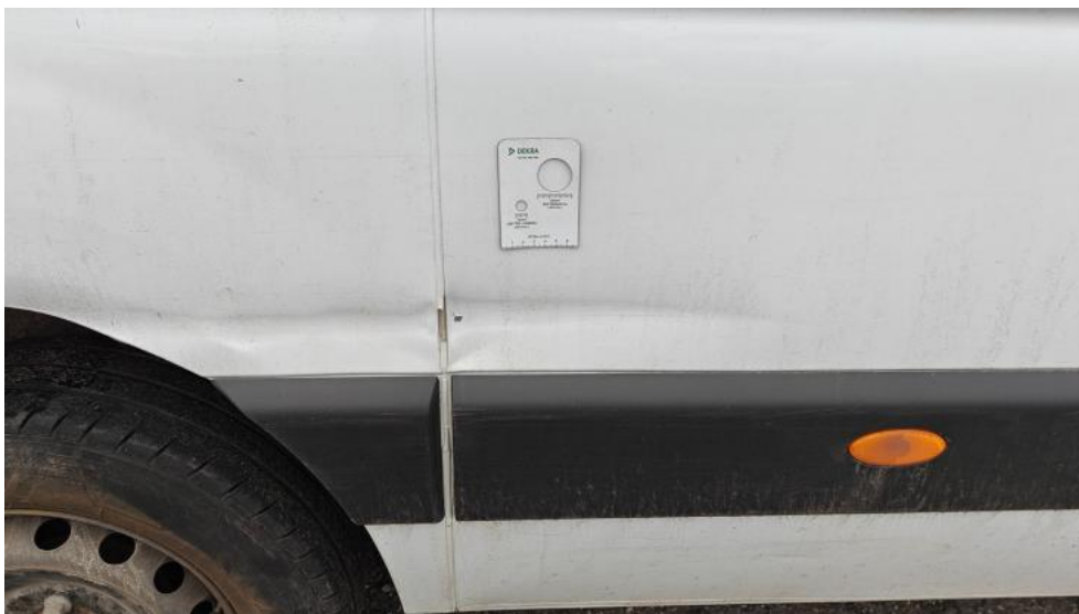
Fot. 33. Błotnik metal TP - wgniecenie 1
