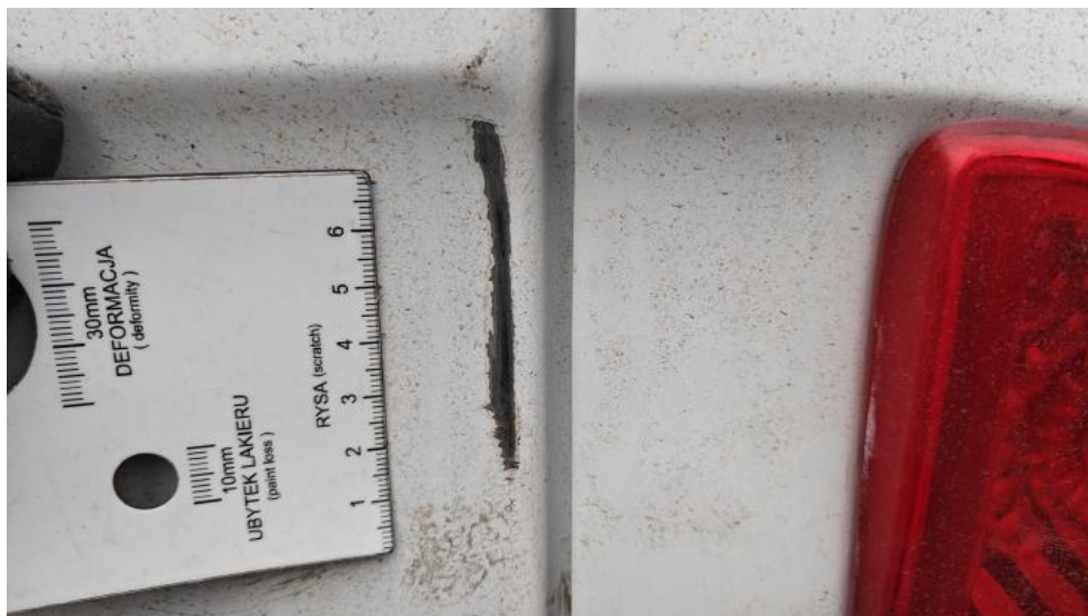
Fot. 51. Drzwi skrzydłowe TL - zarysowanie 1
