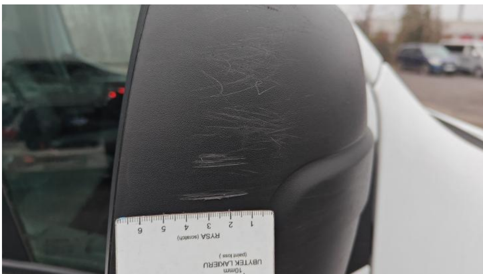
Fot. 84. Obudowa lusterka zewnętrznego n/lakier. P - zarysowanie 1
