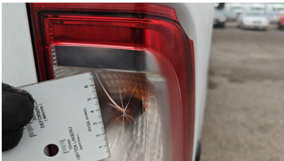
Fot. 42. Lampa żarnikowe TP - pęknięcie 2
