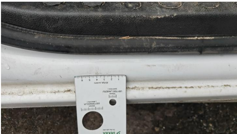
Fot. 79. Próg P - zarysowanie 1
