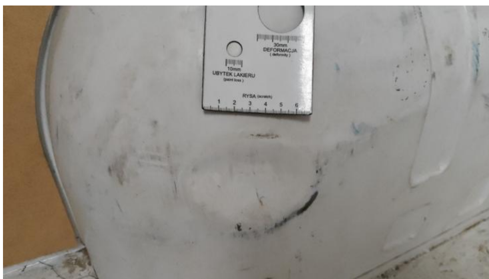
Fot. 60. Ściana boczna TL - wgniecenie 1
