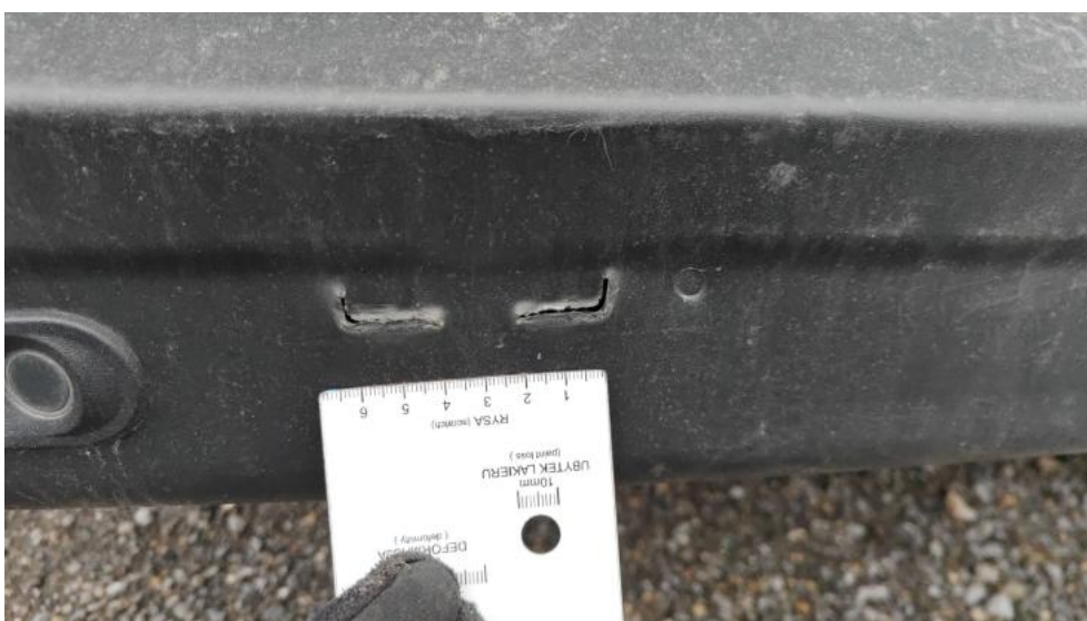
Fot. 90. Zderzak n/lakier. TYŁ - pęknięcie 1
