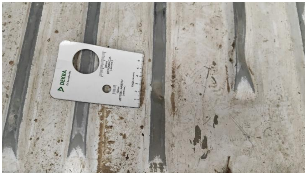
Fot. 101. Podłoga bagażnika - wgniecenie 1
