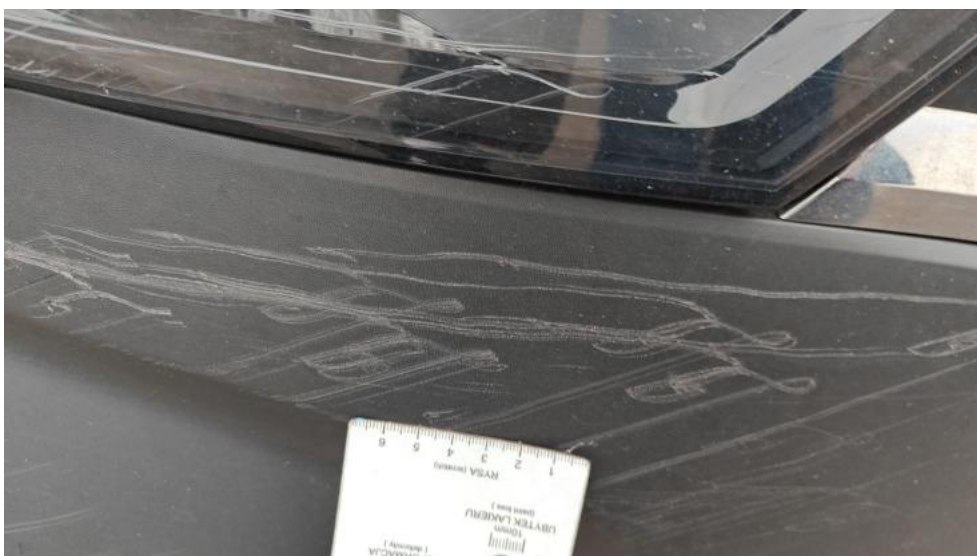
Fot. 70. Zderzak n/lakier. PRZ - zarysowanie 1
