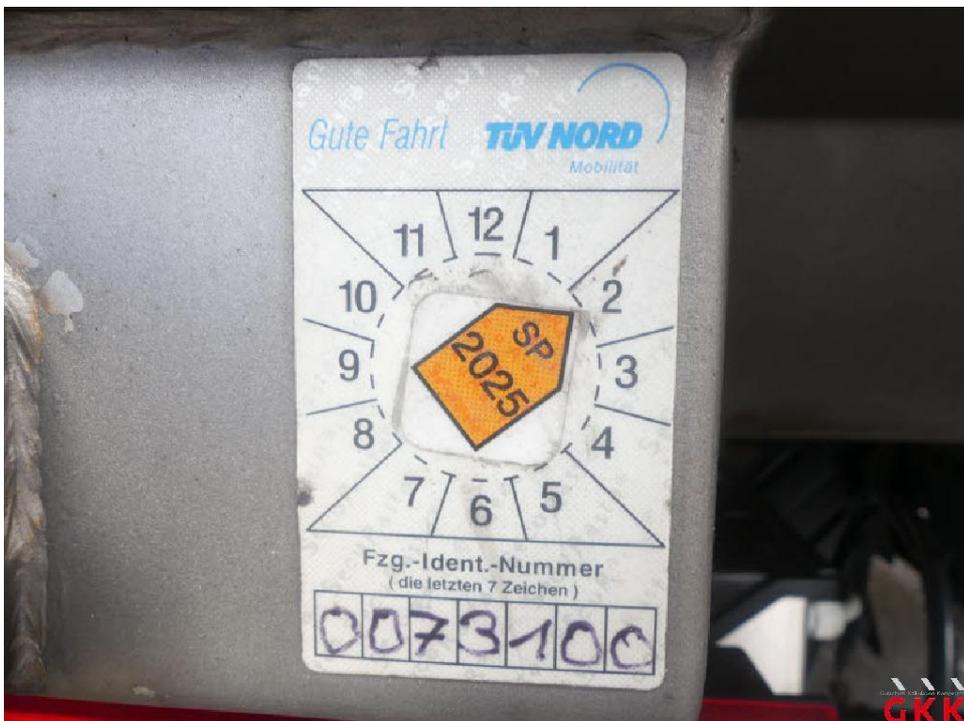
Bild 20 Sicherheits-Prüfung, fällig, durchführen
