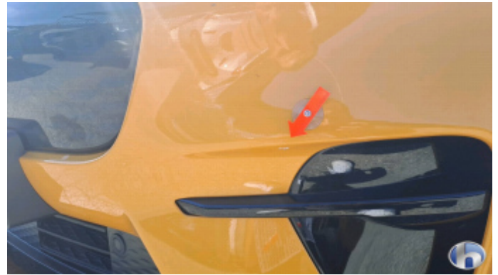
1. paraurti anteriore Scheggiatura - Smart Repair
