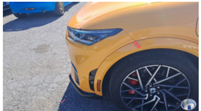
1. paraurti anteriore Scheggiatura - Smart Repair
