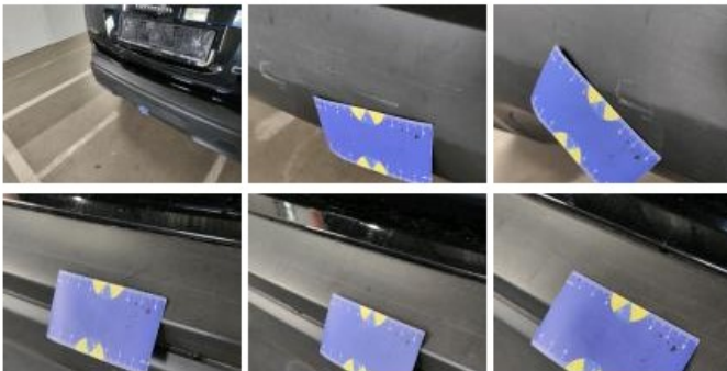
Door RR, Scratch(es), Acceptable
