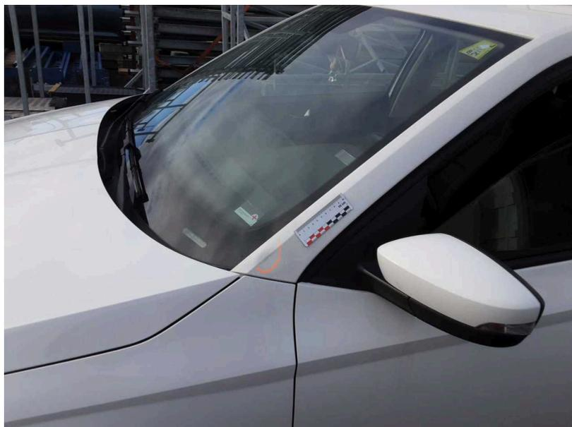
**Beschädigung #4:** Karosserie: A-Säule links - Delle(n) - instandsetzen
