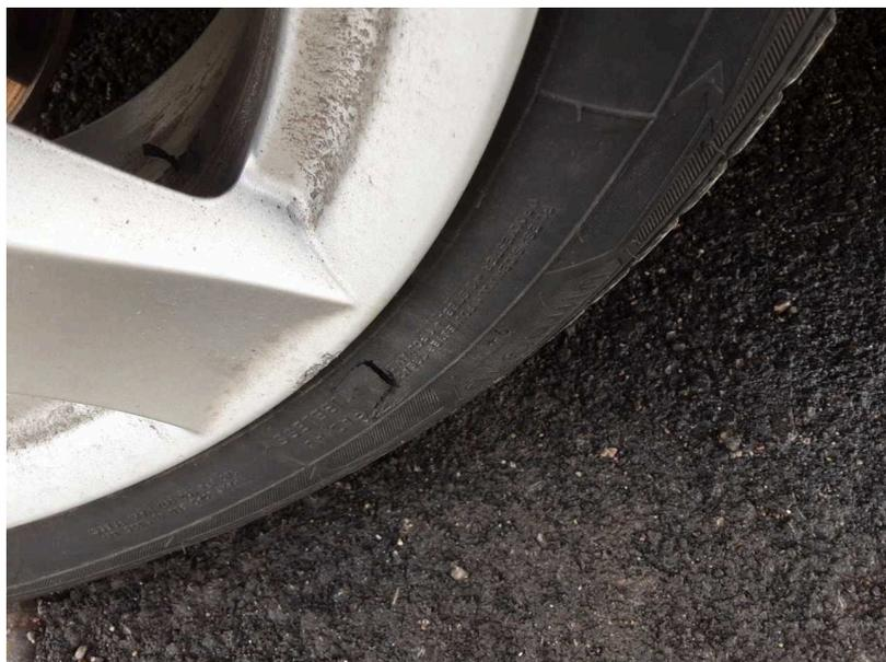
**Beschädigung #6:** Rad/Reifen: Reifen vorn links - gebrochen / gerissen - erneuern
