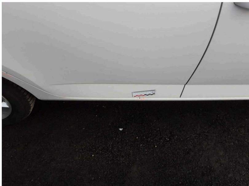
**Beschädigung #5:** Schweller rechts: Schweller - Kratzer - Smart Repair
