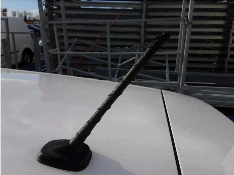
**Beschädigung #1:** Fahrzeugdach: Antennenstab - Marderschaden - erneuern
