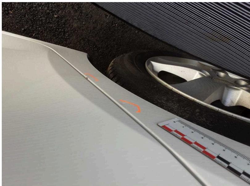
**Gebrauchsspur #3:** Seitenwand rechts: Kotflügel hinten rechts - Delle(n) - kein Abzug
