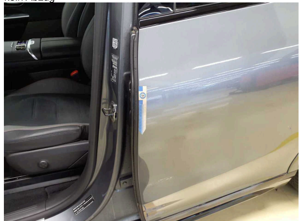
Gebrauchsspur 3: Tür hinten links: Türdichtung (Vorne) - Kratzer - kein Abzug
