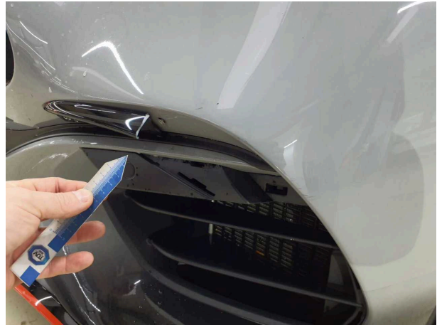
Beschädigung 3: Stossfänger vorn: Spoiler - beschädigt - erneuern
