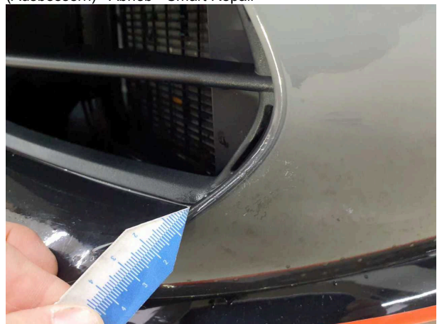
Beschädigung 2: Stossfänger vorn: Stossfänger mit Parktronic (Ausbessern) - Abrieb - Smart Repair
