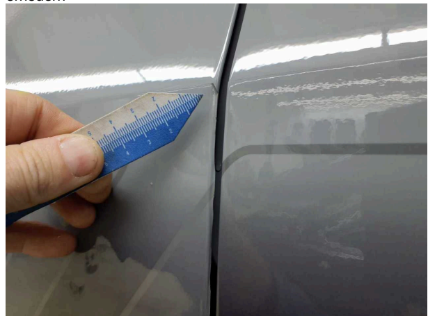
Gebrauchsspur 1: Tür vorn links: Tür (Folien lösen sich) - beklebt/ beschriftet - erneuern
