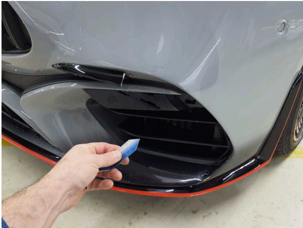
Beschädigung 3: Stossfänger vorn: Spoiler - beschädigt - erneuern
