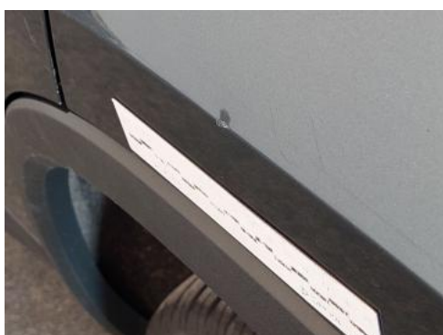
Fot. 43 Błotnik tylny L / Ściana boczna L - Wgniecenie/odkształcenie 1
