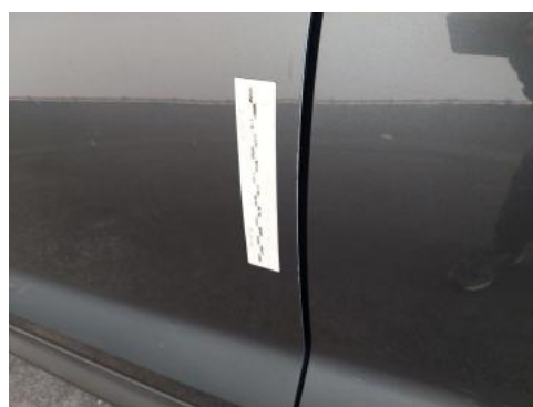
Fot. 44 Drzwi przed L - Rysa/odprysk 1
