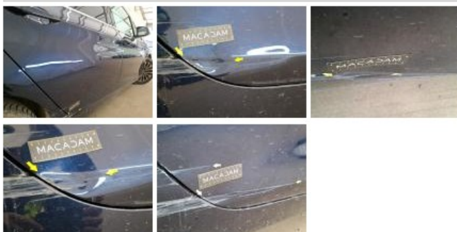
Bas de caisse ext D, Bosse(s) et griffe(s), Le - Remplacer et peindre
