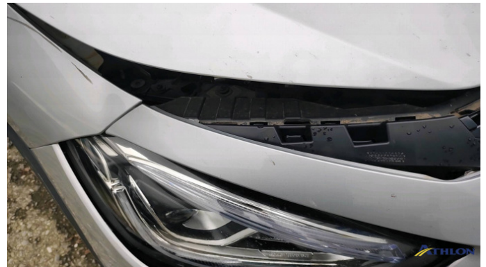
10. faro alogeno - destro Rotto
