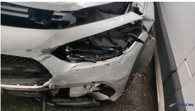
11. faro alogeno - sinistro Rotto
