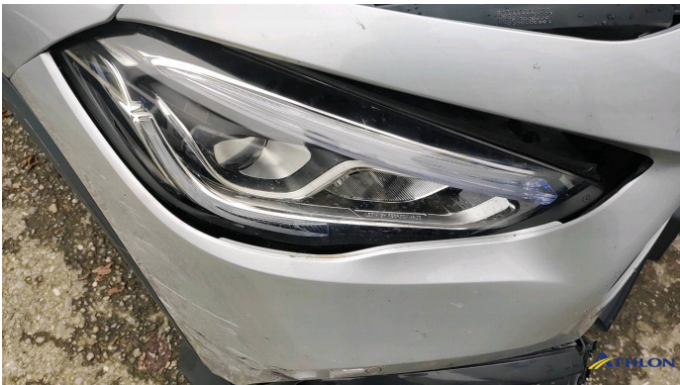
10. faro alogeno - destro Rotto
