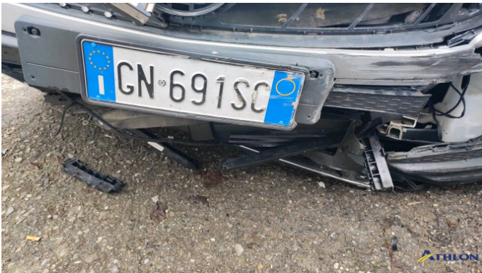
3. griglia anteriore sopra Rotto
