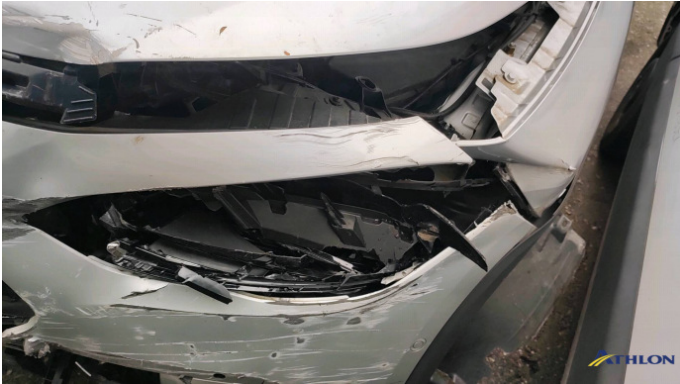
11. faro alogeno - sinistro Rotto
