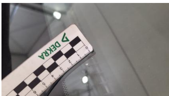
Fot. 35 Szyba czołowa - Rysa/odprysk 1
