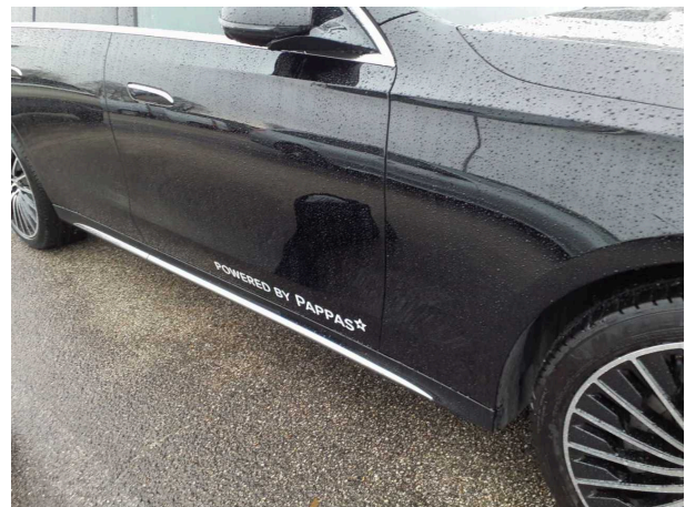
Beschädigung 1: Karosserie: Karosserie (Beklebung entfernen) - beklebt/ beschriftet - entkleben/neutralisieren
